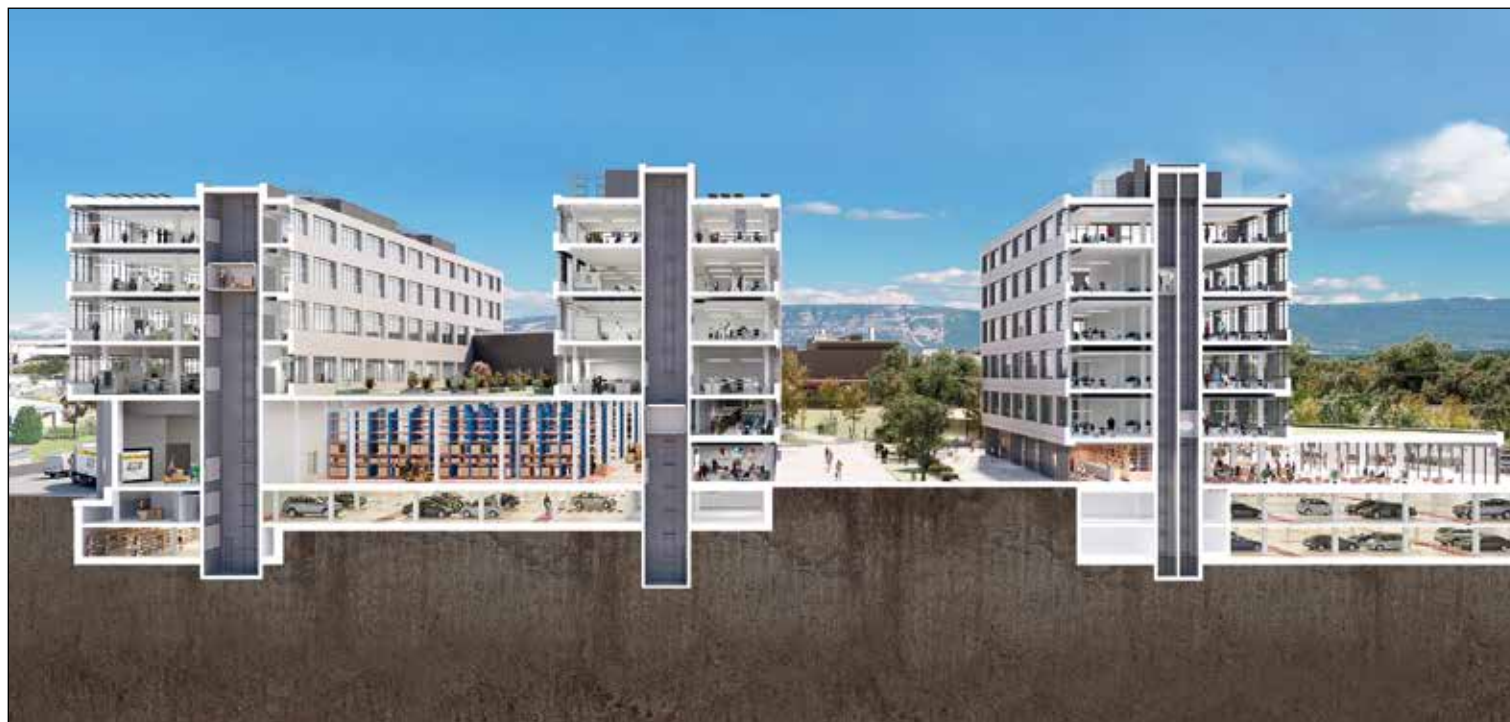
Les immeubles bénéficient d'une desserte verticale efficace via des monte-charges et des ascenseurs de grande capacité.
