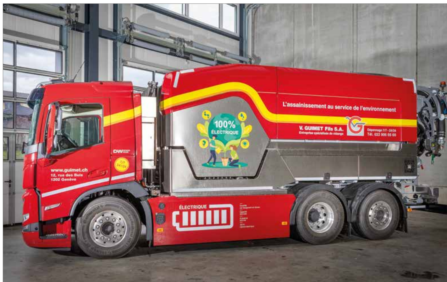
Un camion ultra-performant dont le moteur et l'hydrocureur haute pression sont 100% électriques.
